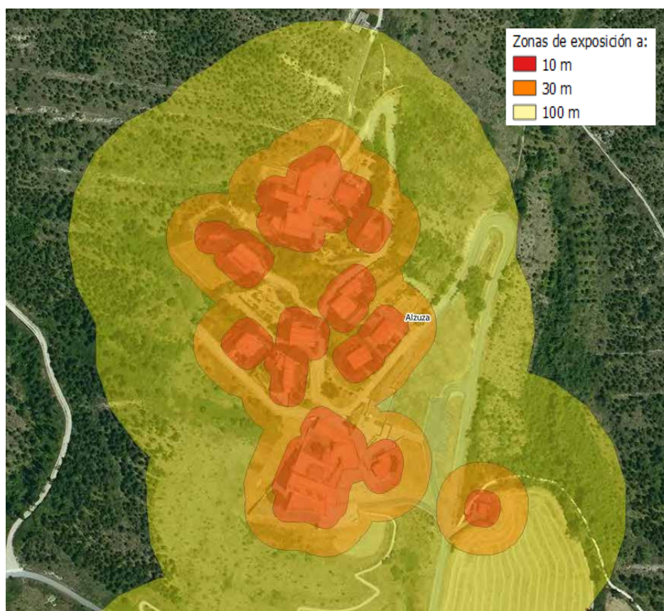
Ilustración 28. Ejemplo de cálculo de las zonas de exposición para edificios en la zona de Alzuza
